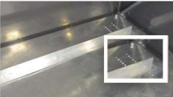
Lattiasa oleva stopperi voidaan helposti asentaa keräysastiatyyppin mukaan
