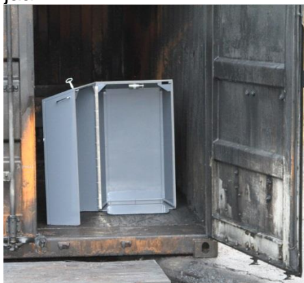
Kuva 1. Metallikaappi ennen polttokokeen alkua.
